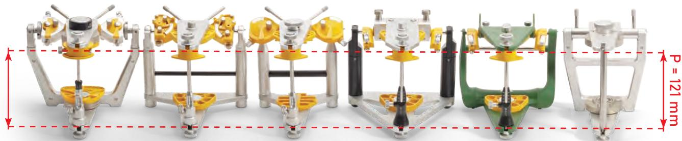
Alle aktuellen Artikulatoren und SAM Instrumente basieren auf der Bauhöhe „P“
